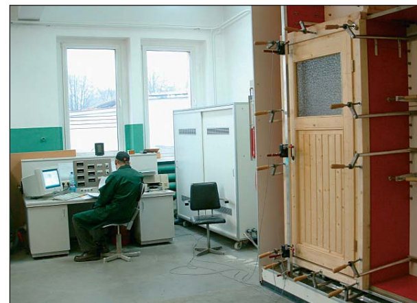
Komora Instytutu Technologii Drewna do badań właściwości eksploatacyjnych okien i drzwi (przepuszczalności powietrza, wodoszczelności, odporności na wiatr)
