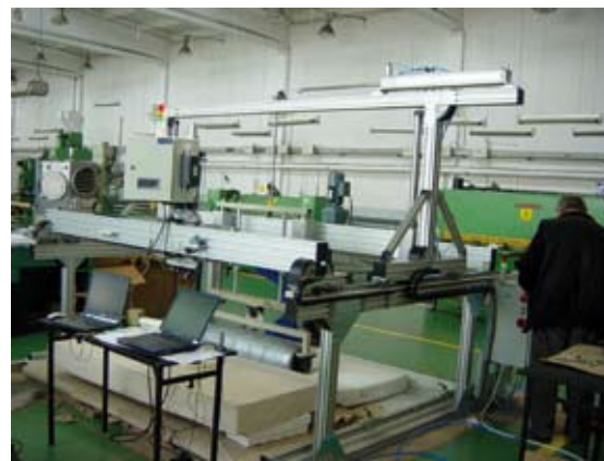
Stanowisko do badania leżysk mebli posiada rolator i twardościomierz.
