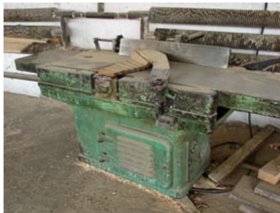
Strugarko-wyrówniarka bez sprawnego układu sterującego.
