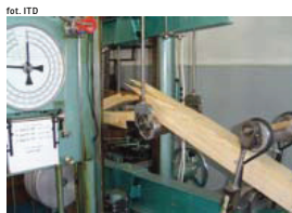
Zostanie zakończony cykl badań nad wartościami charakterystycznymi tarcicy konstrukcyjnej o przekroju prostokątnym.
