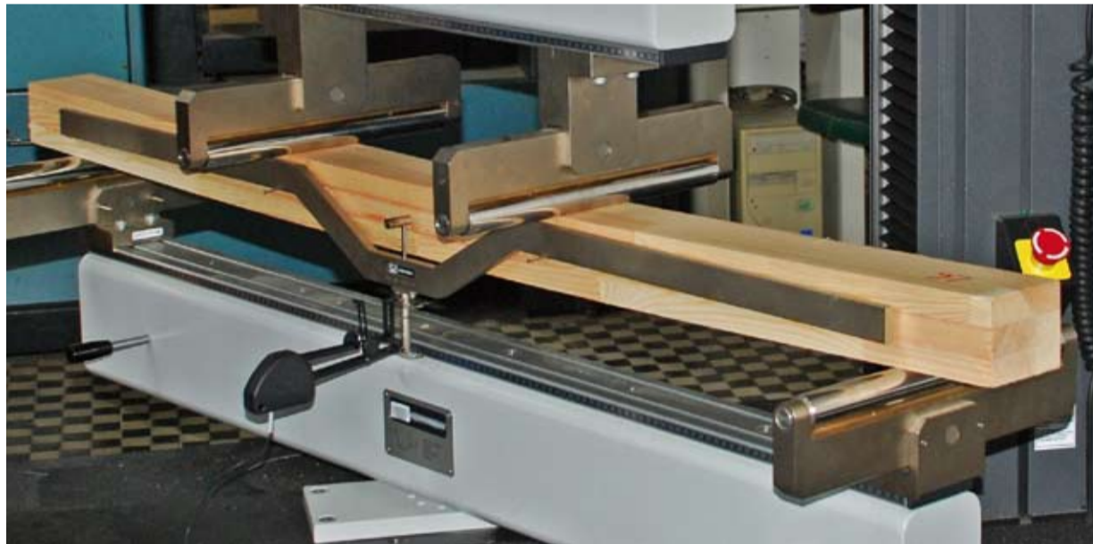
Badanie wytrzymałości na zginanie w schemacie czteropunktowym.
