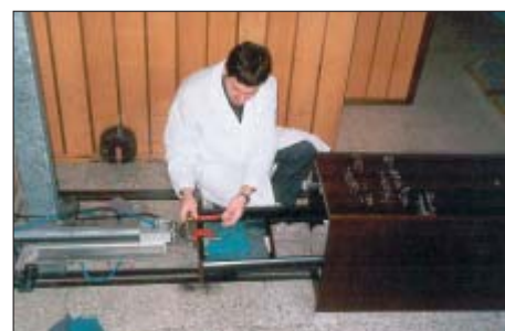
Obciążenie szuflady przed przystąpieniem do zmęczeniowego badania trwałości prowadnic szuflady kontenera biurowego
