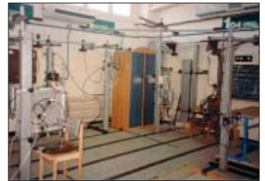
Meble na stanowiskach badania wytrzymałości konstrukcji
