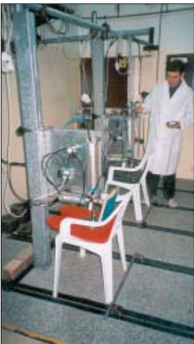
Próba zmęczeniowego obciążenia siedziska krzesła ogrodowych w Instytucie Technologii Drewna
