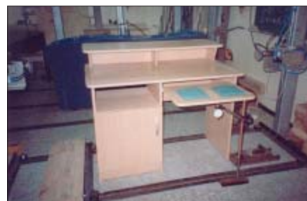
Badanie właściwości użytkowych biurka - oznaczenie sztywności podstawki pod klawiaturę Fot. (6) M. Rogoziński
