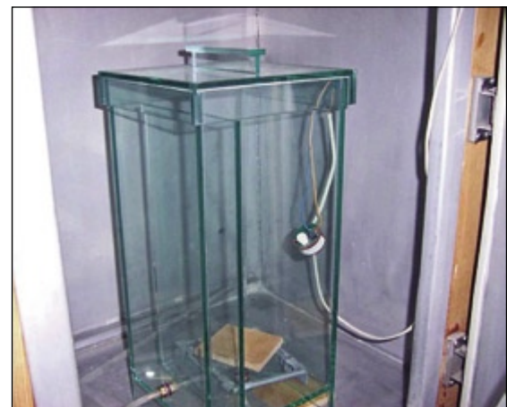
Komora o pojemności 0,025 m 3 do oznaczania stężeń lotnych związków organicznych emitowanych z materiałów stosowanych w meblarstwie
