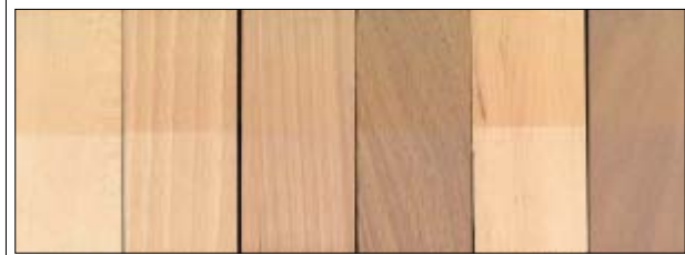
Mziana barwy oklein po 30 h naświetlania w aparacie SUNEST Górna część oklein naświetlano, natomiast dolną przykryto folią nieprzepuszczającą światła. Różnice barwy są bardzo wyraźne i znacznie przekraczają wartość 4 stopnia szarej skali, tj. dE>1,7±0,3
